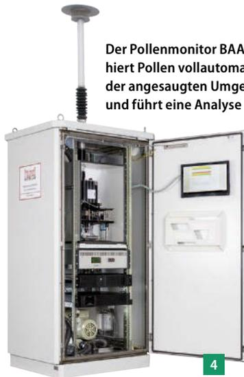
Der Pollenmonitor BAA 500 extrahiert Pollen vollautomatisch aus der angesaugten Umgebungsluft und führt eine Analyse durch.
