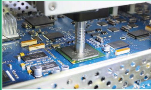
Ausgangspunkt für den Reworkprozess ist immer eine defekte oder fehlerhaft bestückte Baugruppe.
