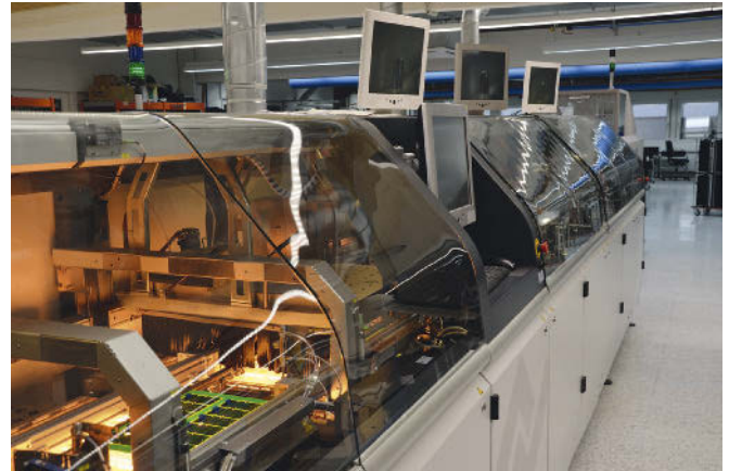
Ersa Inline-Selektivlötanlage Versaflo mit drei Lötiegeln und vorgeschaltetem Versascan-Modul für höchsten Durchsatz.
