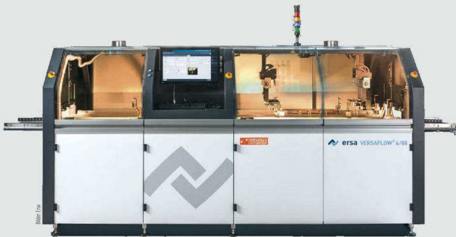
Versaflow 466: Die Selektivlöttechnik von Ersä für Baugruppen von 610 mm x 610 mm Größe.
