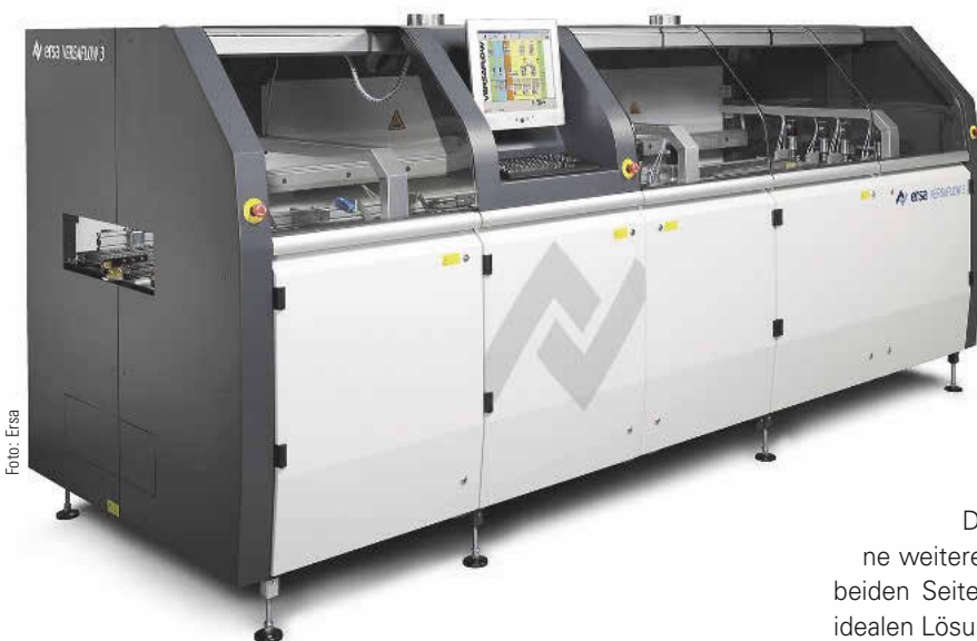
Höchste Flexibilität und höchster Durchsatz bei geringstmöglichem Platzbedarf – dafür steht das Ersä Inline-Selektivlötensystem Versaflow 3/45.
