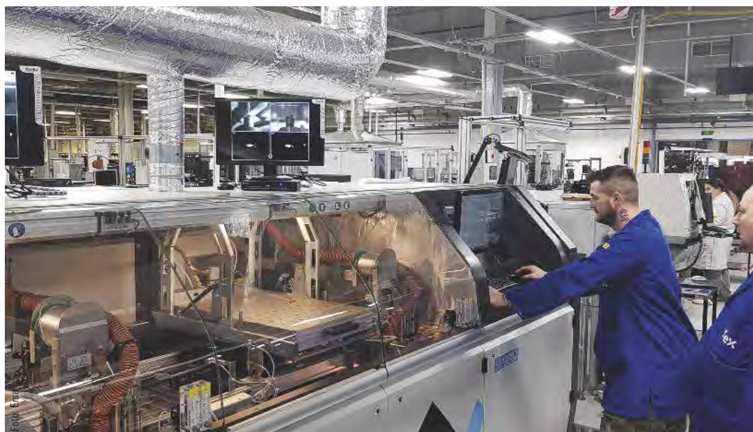
THT-Linie mit Versaflow 3/45 im Zusammenspiel mit dem AOI.
