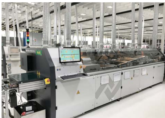
Ersa Selektivlötanlage VERSAFLOW 3/66 in der Paramit-Produktion.
