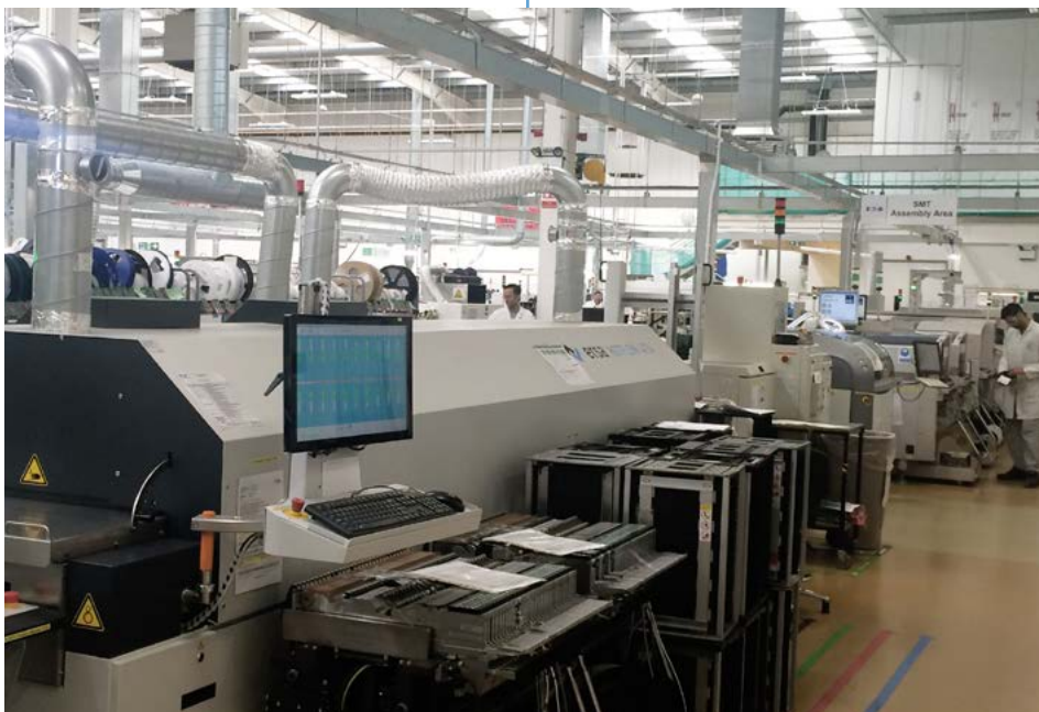
Blick auf die Reflowlötanlage HOTFLOW 4/14 in der Eaton-MTL-Fertigung.
